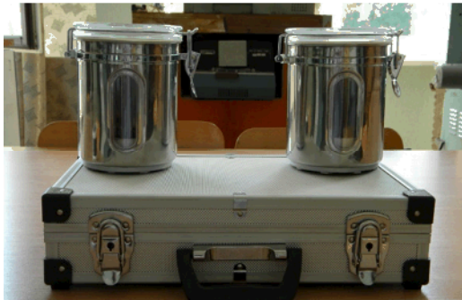
Рисунок 2 – Первинний вимірювальний перетворювач, встановлений на корпусі
