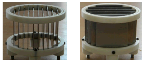
Рисунок 1 – Одна з двох ідентичних частин первинного вимірювального перетворювача
