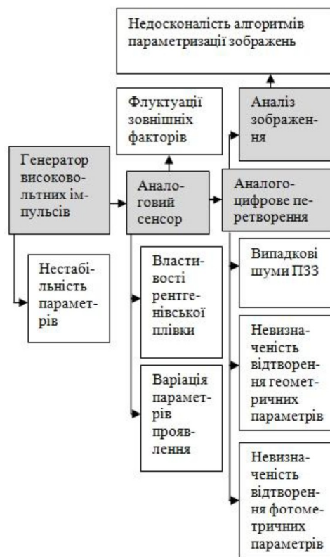
Рисунок 4 – Джерела невизначеності при аналоговій реєстрації та аналізі цифрових зображень газорозрядного випромінювання
