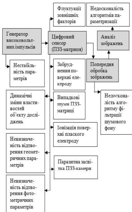
Рисунок 3 – Джерела невизначеності вимірювань при реєстрації та аналізі цифрових зображень газорозрядного випромінювання
