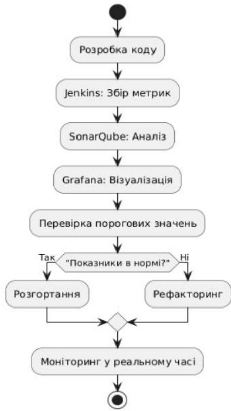
Рисунок 2 – Перевірка метрик SonarQube та подальші дії в Jenkins
