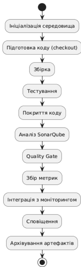
Рисунок 1 – Спрощена схема етапів CI/CD-пайплайну в Jenkins
