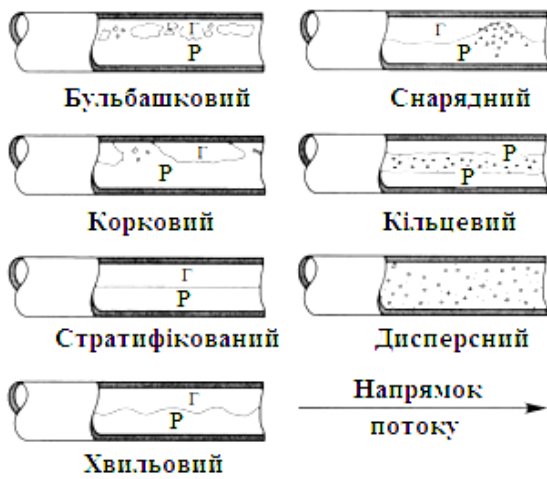
Рисунок 3 – Характерні режими течії фаз у горизонтальній трубі [11]
