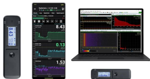
Рисунок 4 – Зображення детектора Radiacode з вікном програмного забезпечення на телефоні та на комп'ютері
