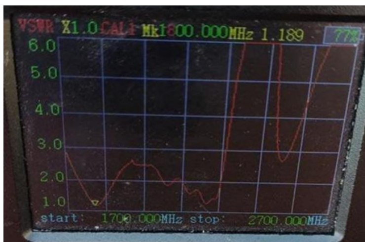
Рисунок 4 – Графік залежності частоти – VSWR (Voltage Standing Wave Ratio) (Port2) [7]
