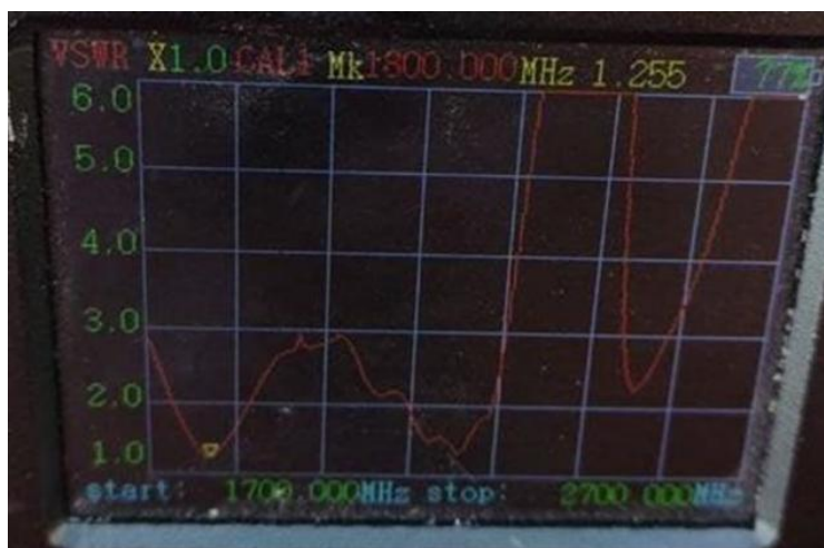
Рисунок 3 – Графік залежності частоти – VSWR (Voltage Standing Wave Ratio) (Port1) [7]
