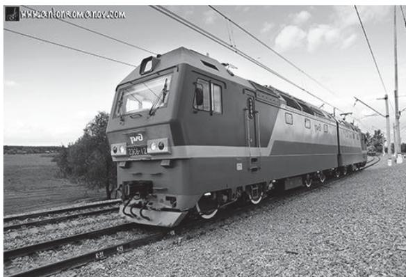
Рисунок 2 – Современный грузовой двухсекционный восьмиосный электровоз постоянного тока 2ЭС6 «Синара» (максимальная эксплуатационная скорость – 120 км/ч)
